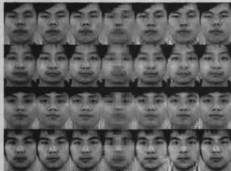
图 2 实验结果比较。(a)、(d)输入的低分辨率图像(32×24; 16×12); (b)、(e)新方法的结果(128×96); (c)、(f)Liu 等人方法的结果(128×96); (g)真实图像(128×96)
